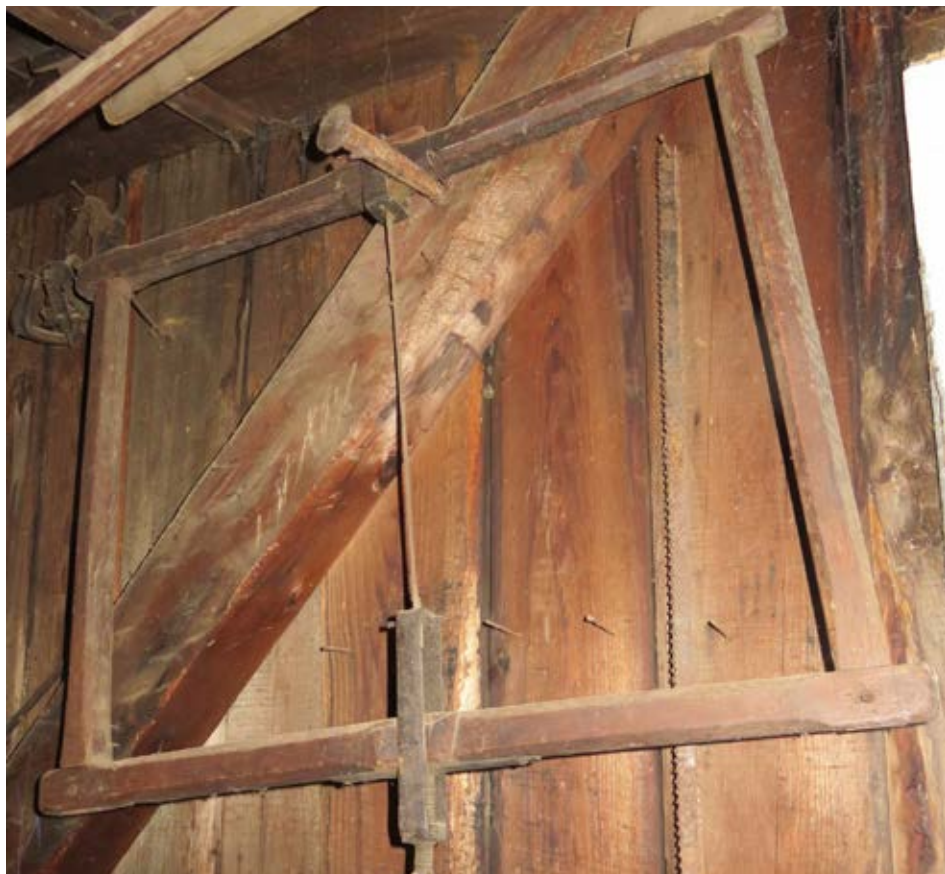
Les scies à châssis servent à couper le bois en planches.
