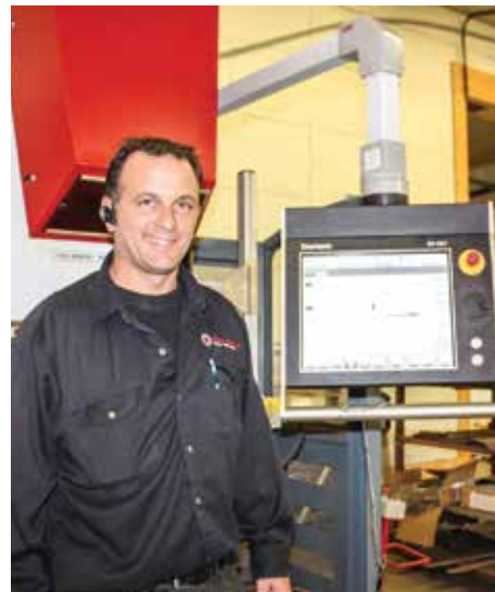
Pour plier l'acier, Jules Roberge utilise une presse-plieuse contrôlée numériquement.
